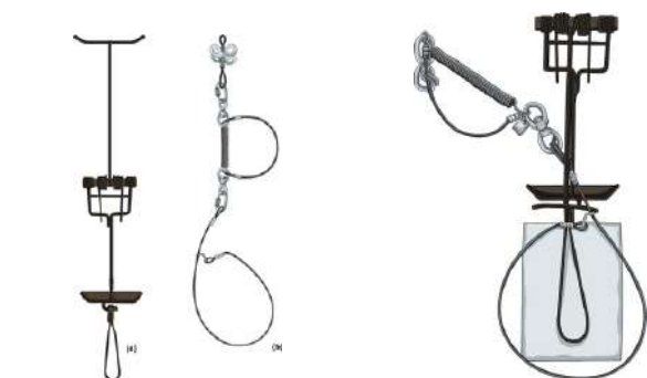
Figura 05: Representação esquemática de armadilha de laço indicando o sistema de catapulta (A-a); laço com sistema de amortecimento (A-b); representação dos sistemas montados (B) e ilustração da armadilha montada em trilha (C).
